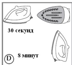
Функция автоматического выключения утюга действует следующим образом: Оставленный на подошве или опрокинутый на бок утюг, который нагрелся до определенной температуры, но не эксплуатируется, автоматически отключится через 30 секунд. Если утюг не эксплуатируется и находится на пяте-опоре в вертикальном положении - режим автоматического отключения сработает через 8 минут (рис. D).
